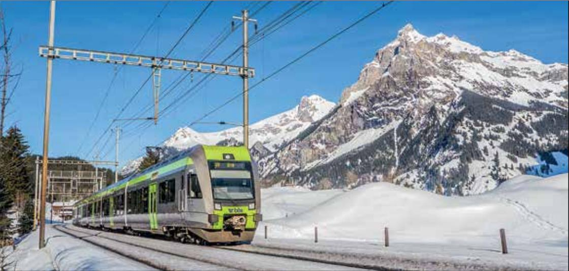
▲ Die BLS verwenden wie die DB, ÖBB und SBB den einphasigen Wechselstrom von 15.000 Volt und einer Frequenz von 16,7 Hertz. Hier begegnet uns ein «Lötschberger»-Triebzug bei Kandersteg.
